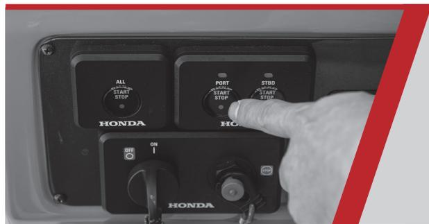
BF115からBF350のDBWモデルでは、幅広い船体タイプにマッチする洗練されたデザインのスイッチパネルをラインナップしています。
