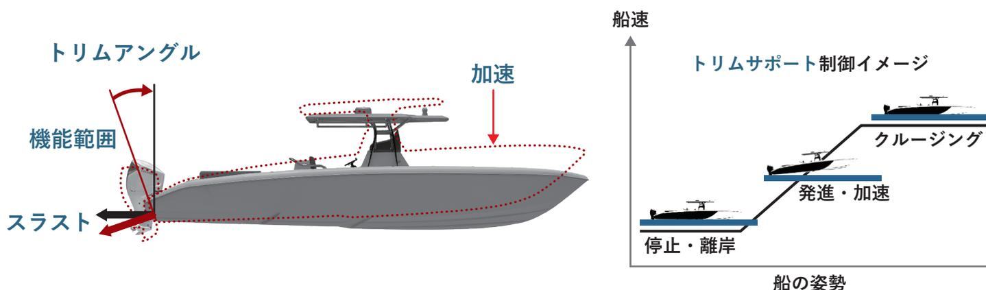
トリムサポートを使用する場合、使用する船や状況に合わせてパターンを選択します。
